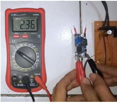
Gbr. 11 Pengujian Input Buck Converter LM2596
