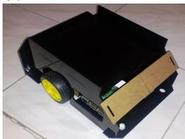
Gambar 7. Robot yang telah dibuat dari bahan acrylic
